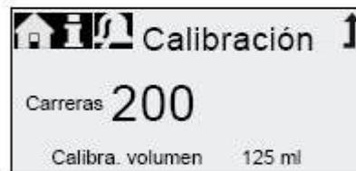
6. Quitar la tubería de aspiración del vaso de precipitados y comprobar el volumen restante  $V_2$  (170 ml).
