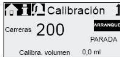
5. La bomba ejecuta 200 carreras de dosificación y muestra el valor de calibración de fábrica (125 ml).
