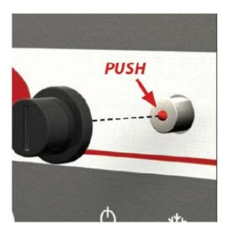
Si la température du générateur dépasse 103 °C, ce dispositif de sécurité arrête le générateur. Pour fonctionner à nouveau, la température de générateur doit descendre endessous de 60°C. Retirez ensuite le couvercle et appuyez sur le bouton de réarmement avec un stylo ou tout autre objet pointu, puis remettez le couvercle.
